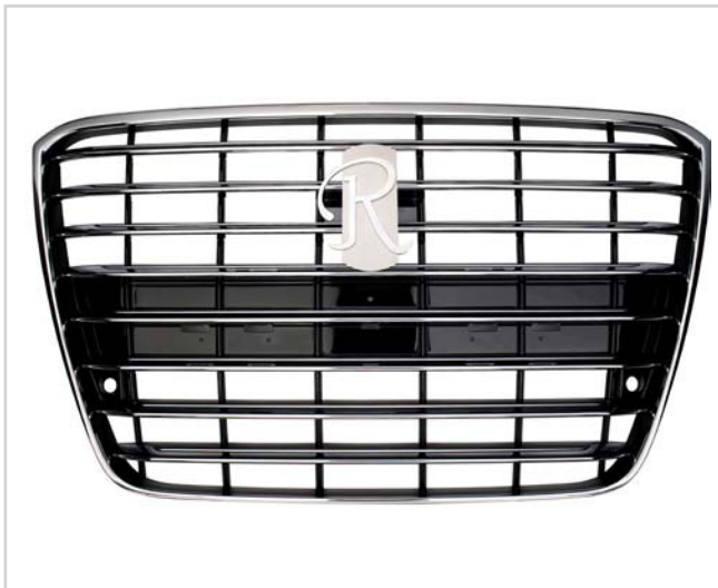
Audio A8 Audi Logo entfernt und durch Logo ersetzt, Werkstoff: 1.4301 Edelstahl, Oberfläche: poliert
