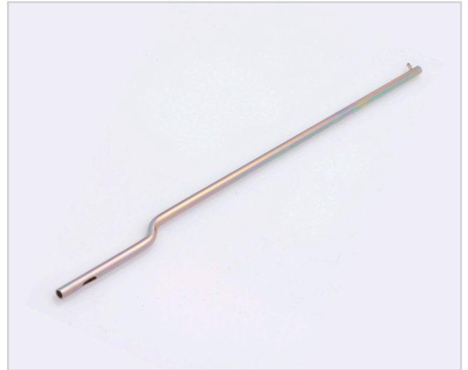
Messingrohr D=4x0,5mm mit Einfräsung und ausgezogener Nase, Werkstoff: Messing, Oberfläche: gelb verzinkt
