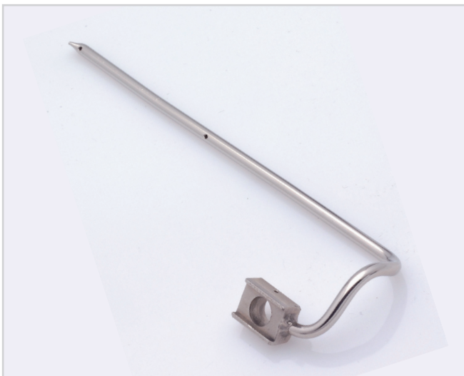
Rohr D=5x1 mm mit angesetztem Frästeil, Werkstoff: 1.4571 Edelstahl, Oberfläche: elektropoliert
