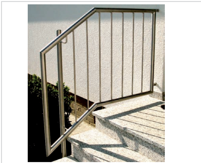
Rohr Geländer für Treppenaufgang, Werkstoff: 1.4301 Edelstahl, Oberfläche: geschliffen Korn 240
